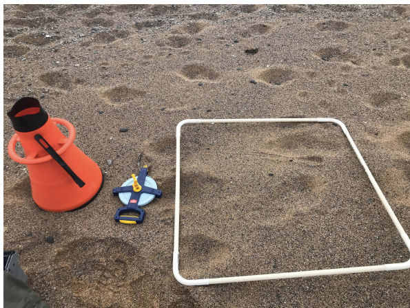
Figur 2: Vid inventeringen användes undervattenskikare, måttband och en 1x1 meter provruta av PVC-rör. Foto: Beatrice Persson
